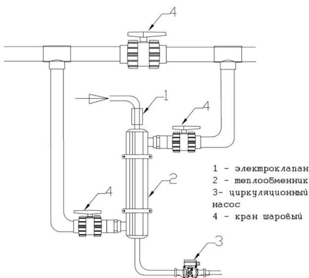
Для обвязки вторичного контура рекомендуется применять разъемные муфты с резьбовыми вставками из нержавеющей стали. Резьбовые соединения уплотнять фумлентой или герметиками.
